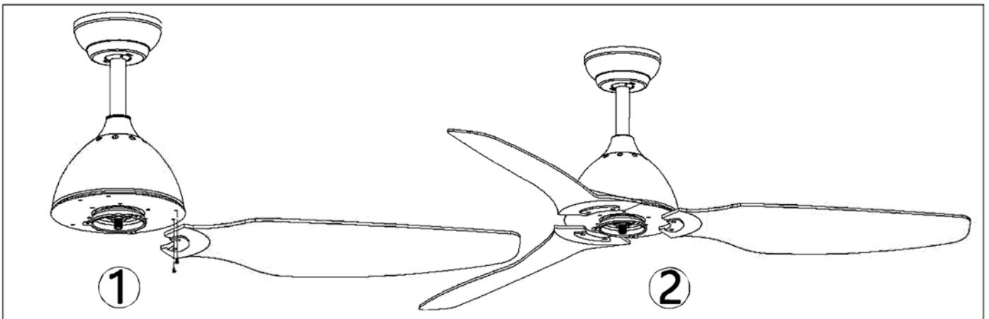
**6- Montaje de la placa iluminación.** Montar el plafón metálico fijándolo bajo las aspas.
